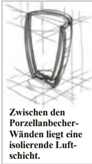
Zwischen den Porzellanbecherwänden liegt eine isolierende Luftschicht.
